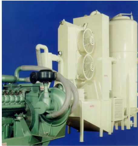
Gasifier + Cogenerator (ET.Martezo)
