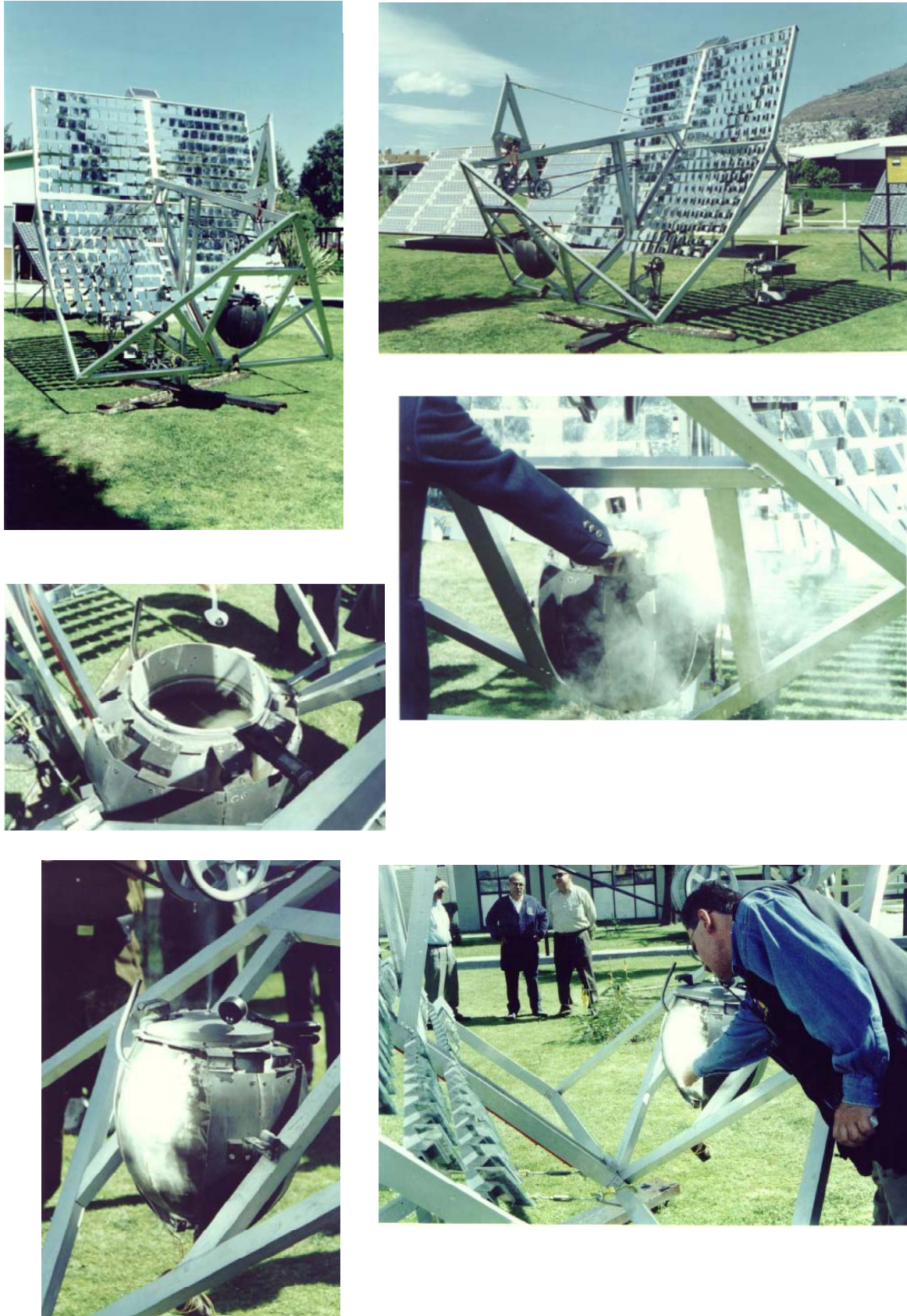
Figura 6: Composición fotográfica de la estufa solar rural de concentración en diferentes etapas de operación con una eficiencia bajo condiciones de prueba del 64 %
