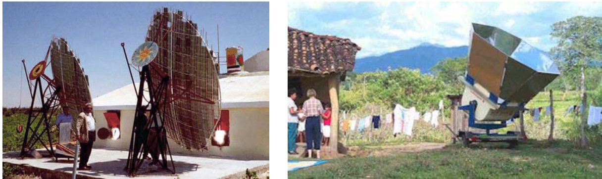
Figura 3 Muestra de dos trabajos de estufas solares en Egipto y en Centro América, con potencias útil mayores al kW.
